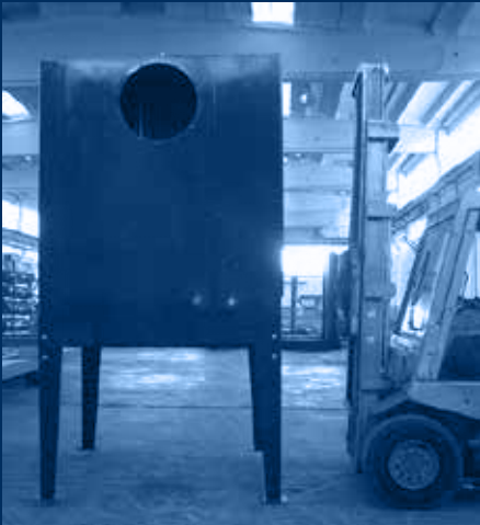
vista unità filtrante / filtering unit view
