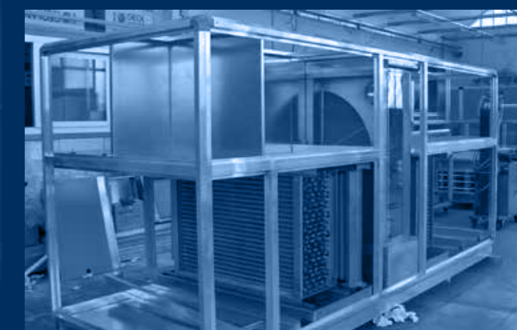
vista UTA in fase di costruzione / UTA under construction
